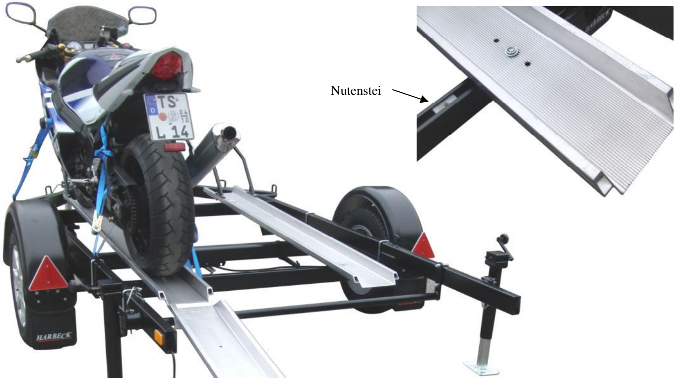
B 1000 MO-AL - Breite 1,45 m, Aluschienen Zubehör: Zweite Standschiene Stützfüße klapp- und spindelbar LM-Felgen Lack mattschwarz
