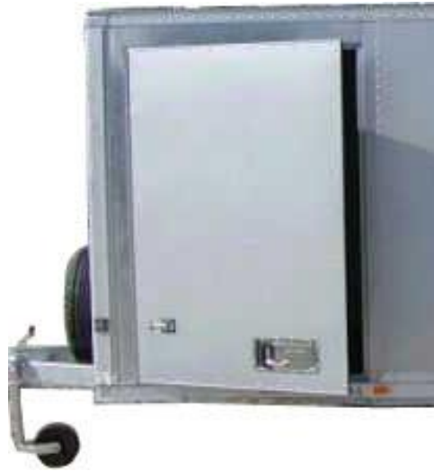
Seitentüre, Niroverschluß nur von außen zu Öffnen, Türfeststeller
