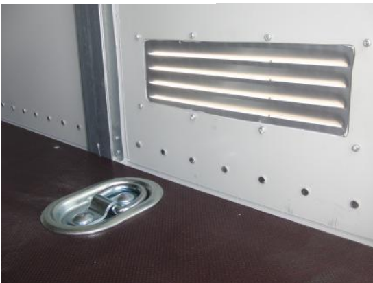
Zurrmulde im Holzboden, Lüftungsgitter
