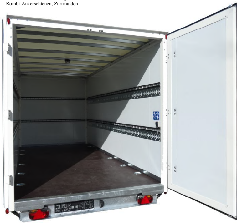
Zurrmulde im Holzboden, Lüftungsgitter
