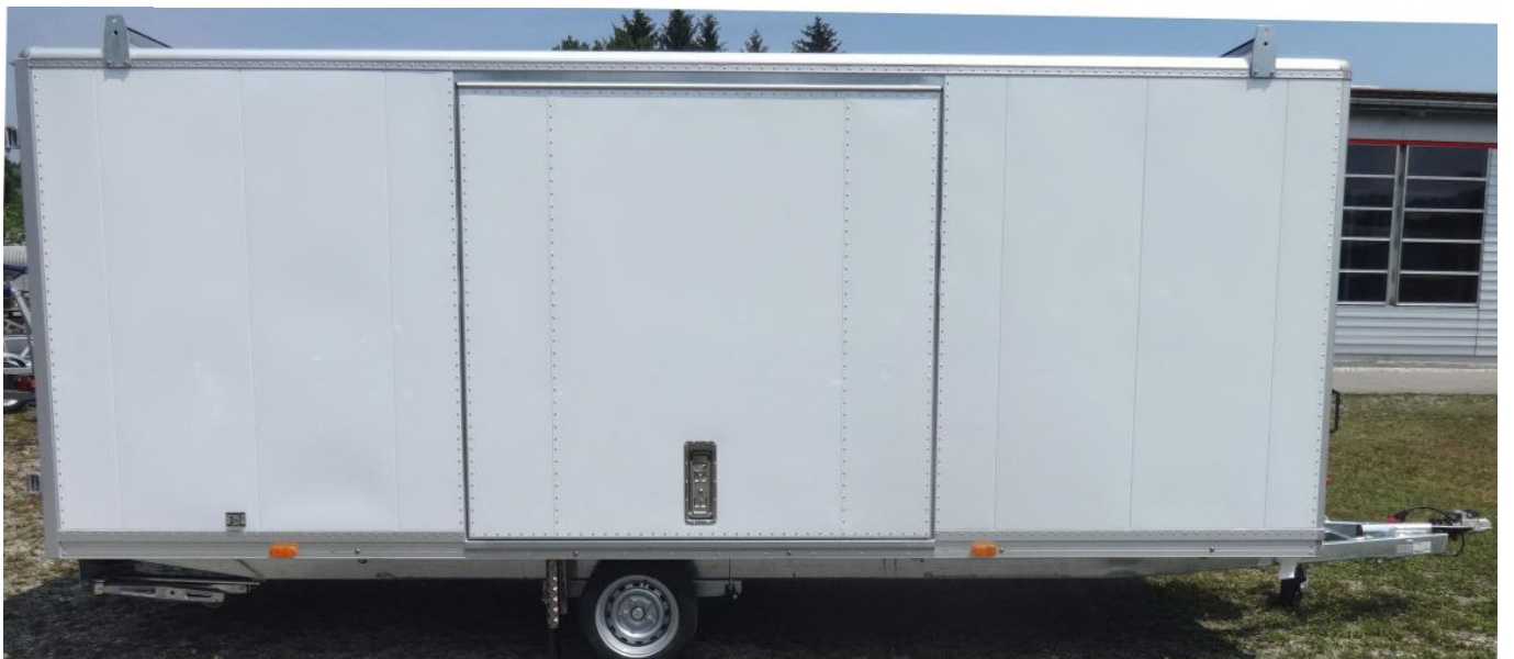
Seitenklappe, Ausdrehstütze, Rangiergriffe, Dachstreben
