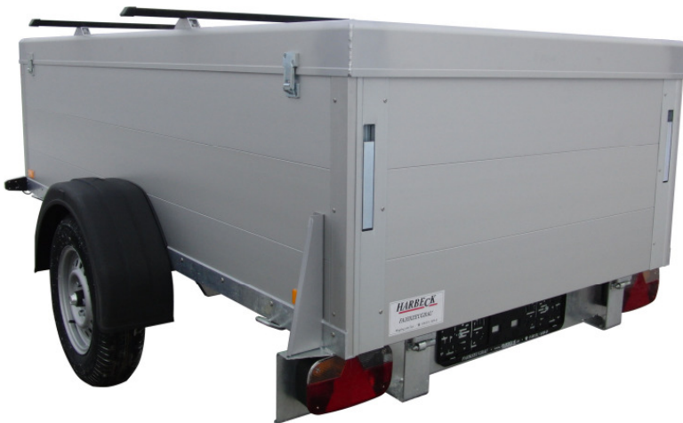
750 K-AL-06 – 2,5 x 1,25 m Bordwandhöhe 600 mm Zubehör: Alu-Deckel, Deckeltraversen
