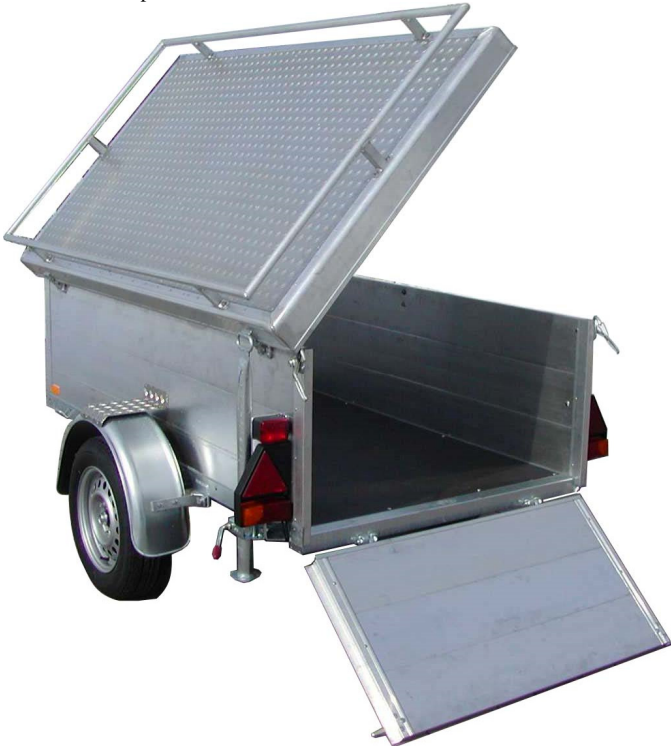
B 800 K-AL-06 – 2,1 x 1,15 m - Bordwandhöhe 600 mm, Oberfläche walzblank, Beleuchtung seitlich, Kennzeichen an Heckklappe Zubehör: Aludeckel, Deckelreling, zusätzliches Riffelblech auf Deckelglattblech, Stützfuß, Winkelhebelverschlüsse, Blechkotflügel nicht anliegend, Tritt auf Kotflügel
