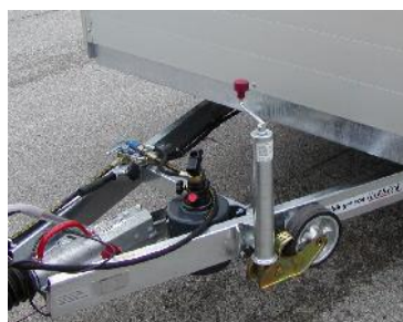
Zubehör: Stützrad mit Flansch, halbautomatisch klappbar
