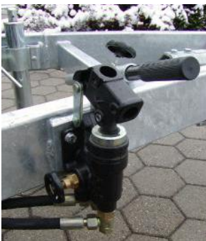
Notpumpe, serienmäßig bei Elektropumpe
