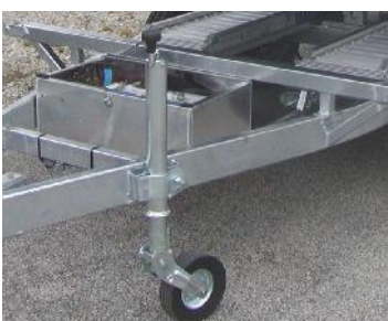
Zubehör: Stützrad vollautomatisch klappbar
