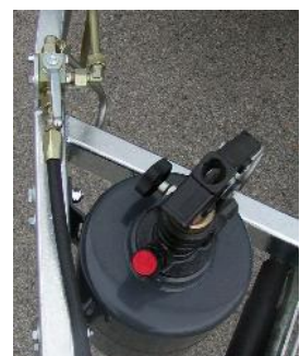
Zubehör: Dreiwegehahn für Handpumpe und Schlepperanschluß
