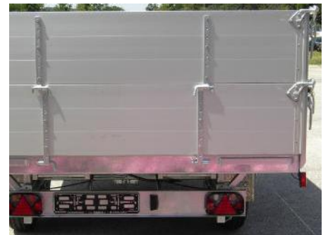
Zubehör: Heckbordwand und Aufsatzbordwand pendelnd mittels Zusatzscharnier verbunden
